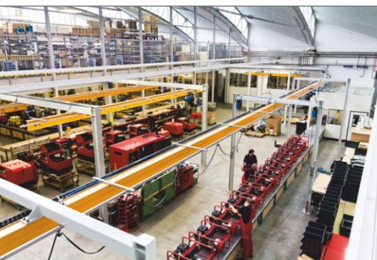
Gut gerüstet für zukünftige Aufgaben ist die Produktion der mobilen Stromerzeugerlinien von ENDRESS in Bempflingen. Auf einer Fläche von ca. 4.000 m<sup>2</sup> werden am Hauptsitz des Unternehmens Stromerzeuger für Feuerwehr, Bauindustrie und Landwirtschaft hergestellt. Durch die Ausrüstung mit modernster Fertigungs- und Prüftechnologie haben wir sichergestellt, dass jeder Stromerzeuger den jeweils geltenden Normen und Vorgaben entspricht.
